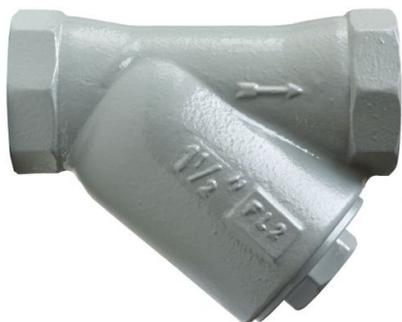
**Werkstoffe:** Gehäuse: Grauguss GG 25 (JL 1040), Sieb: Edelstahl 1.4301 (ab DN 150 Lochblech 1.4301), Deckeldichtung Graphit mit Spießblecheinlage
