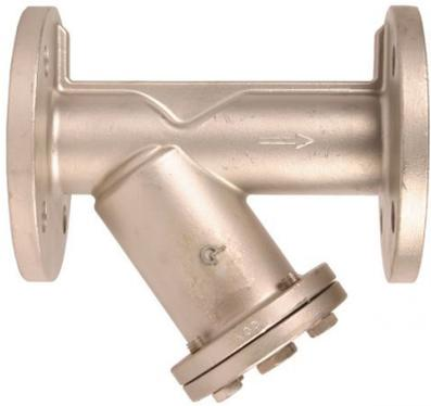
**Werkstoffe:** Gehäuse und Flanschen: Schmiedestahl C22, Sieb: Edelstahl Lochblech 1.4301, Deckeldichtung: Graphit mit Spießblecheinlage
