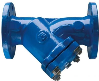
**Werkstoffe:** Gehäuse: Sphäroguss GGG 40 (JS 1030), Sieb: Edelstahl 1.4301 (ab DN 150 Lochblech 1.4301), Deckeldichtung Graphit mit Spießblecheinlage
