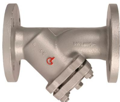
**Werkstoffe:** Gehäuse: Grauguss GG 25 (JL 1040), DN 350/400 GGG 50 (ENG-GJS-500-7), Sieb: Edelstahl 1.4301 (ab DN 150 Lochblech 1.4301), Deckeldichtung Graphit mit Spießblecheinlage/DN350: EPDM
