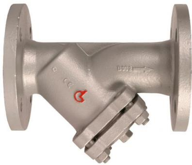
**Werkstoffe:** Gehäuse aus Grauguss GG 25, Sieb Edelstahl 1.4301 (ab DN 150 Lochblech 1.4301), Deckeldichtung Graphit mit Spießblecheinlage
