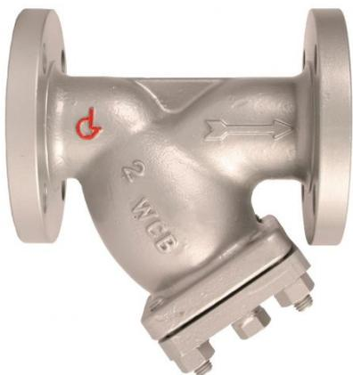
**Werkstoffe:** Gehäuse: Stahlguss A216 WCB, Sieb: Edelstahl 1.4301, Deckeldichtung Graphit mit Spießblecheinlage
