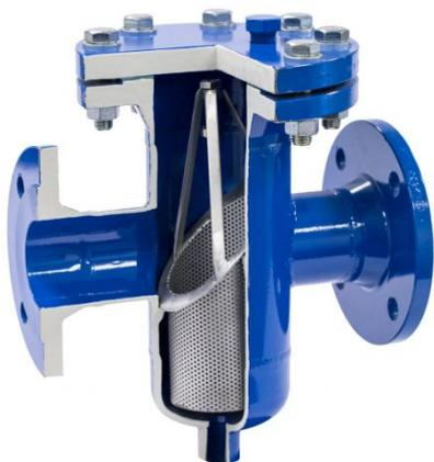
**Werkstoffe:** Gehäuse: S355J2H, Deckel: P265GH, Flanschen: G235JRG2, Sieb: Edelstahl 1.4301, Deckeldichtung Graphit mit Spießblecheinlage
